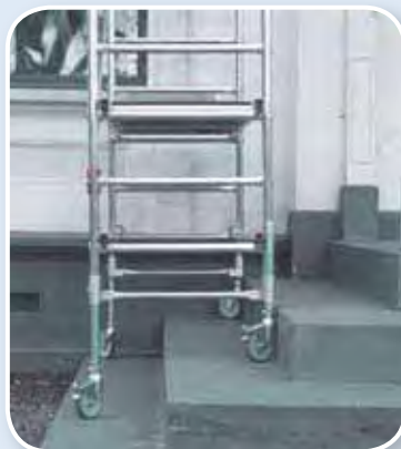
Door telescopisch instelbare driehoeksstabilisatoren en verstelbare wielen kan de steiger worden aangepast aan een ongelijke ondergrond
